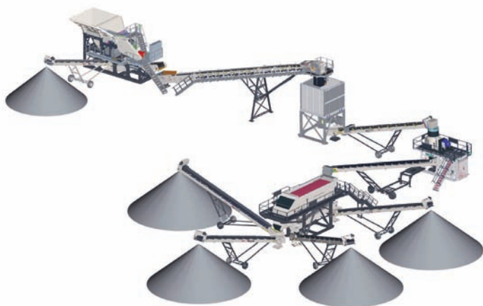
Installation modulaire System 200 à circuit ouvert, 2 étages (Mâchoire-cône-crible)
